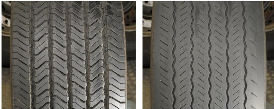
Figur 15. Förändringar i däkmönstret mellan ett nytt däck och ett däck med 5 mm mönsterdjup.
