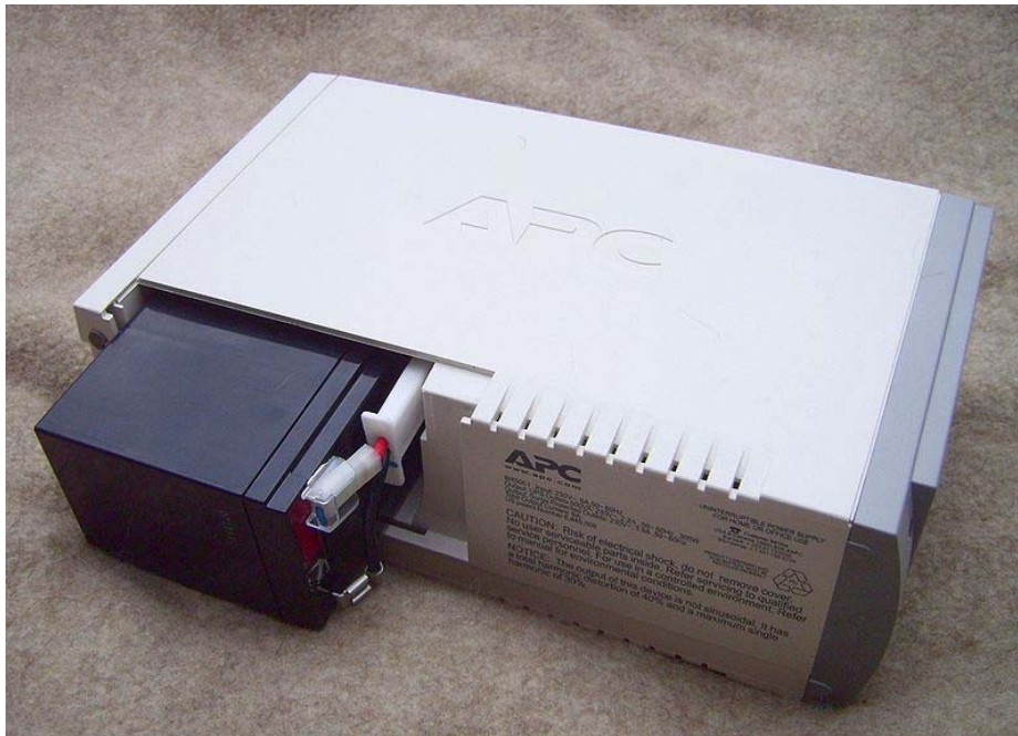
Exempel på UPS
