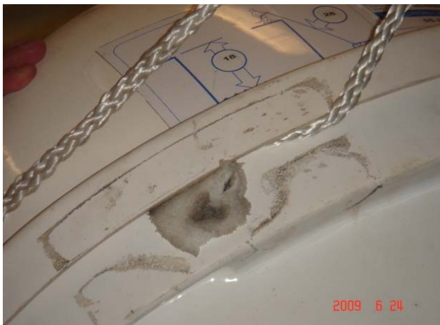
Utlösninglina som löper fel och med risk att fastna.
