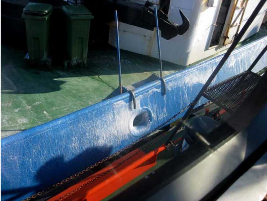
Bildtext: Det inåtlutande räcket syns tydligt på denna bild.
