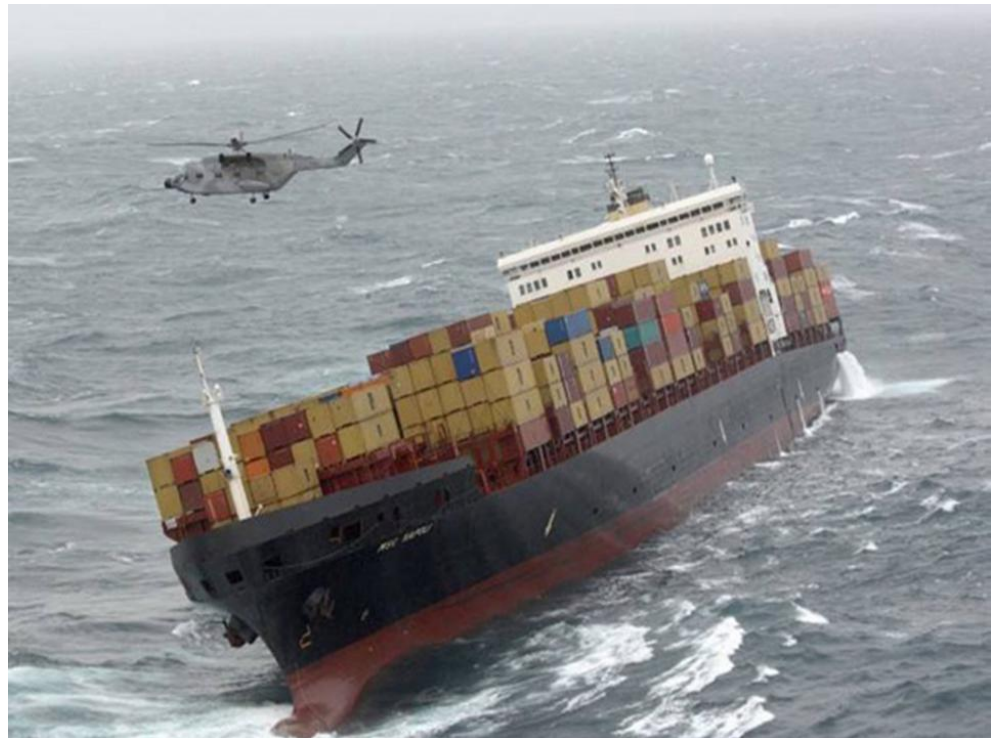
På skrovets babordssida, rakt under bryggvingen, syns tydligt en spricka. Bild: Marine Nationale.
