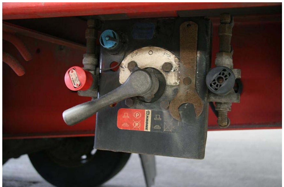
Den röda ventilen ("knappen") är Brysselventilen
