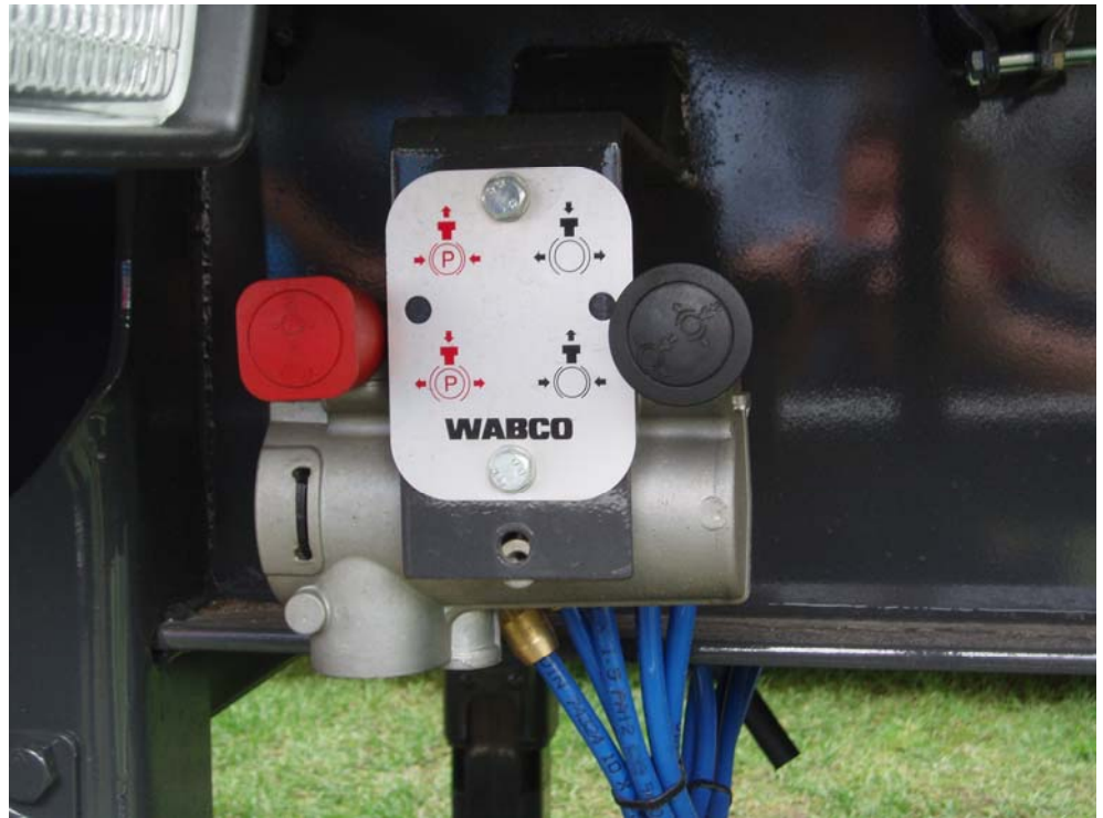
Den röda ventilen ("knappen") är Brysselventilen
