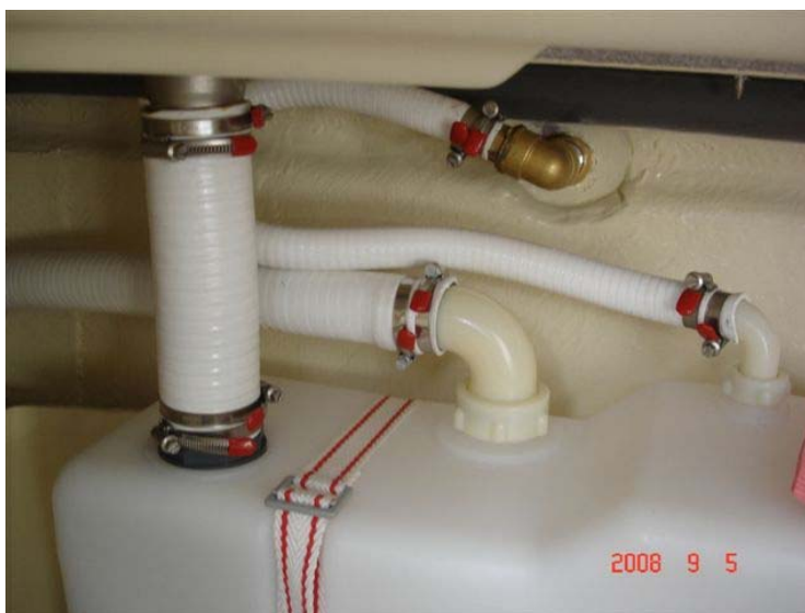
Figur 3. Exempel på installation av septiktank i båt
