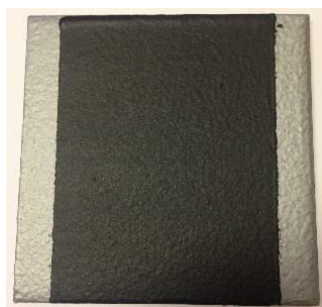
Figur 6. En stålpanel med underliggande grå primer (PPG Sigmaprime 200) och överliggande svart sealer (PPG Sigmacover 555). På dessa monterades sedan standarderna med tennfärg.
