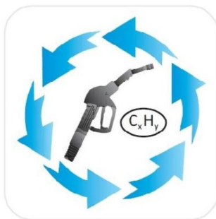
Figur 1. För system utan automatisk övervakning. Munstycket ska vara svart och omgivande pilar blå i en öppen cirkel. Storleken ska vara 40 x 40 millimeter.
