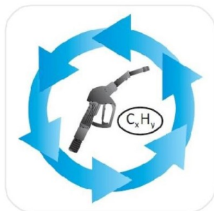
Figur 2. För system med automatisk övervakning. Munstycket ska vara svart och omgivande pilar blå i en sluten cirkel. Storleken ska vara 40 x 40 millimeter.
