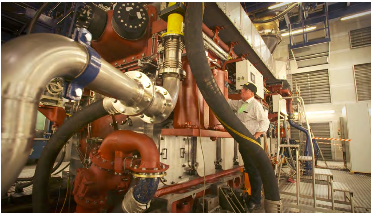
JIP LNG CONV består av Furetank, MAK, Catepillar, FKAB, Öresundsvarvet och SSPA. Här inför konvertering av huvudmaskin på ett fartyget.
