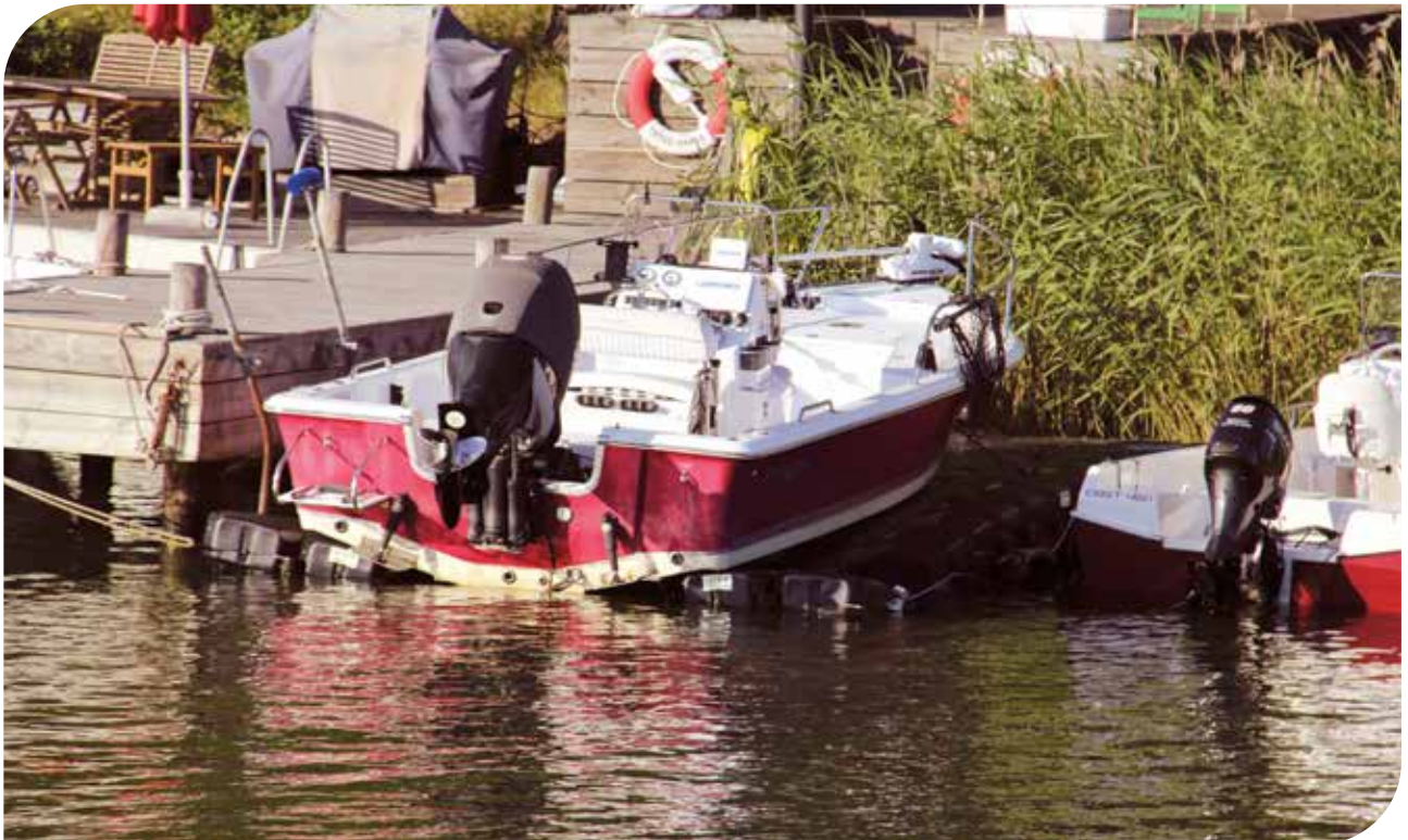
Båtlyft för att motverka bevuxning på båtbottnen.
